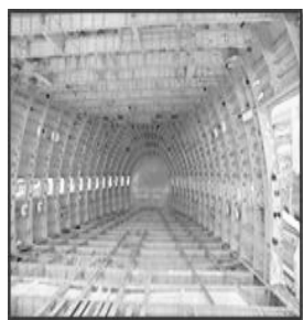
ジャンボジェットの胴体内部構造
